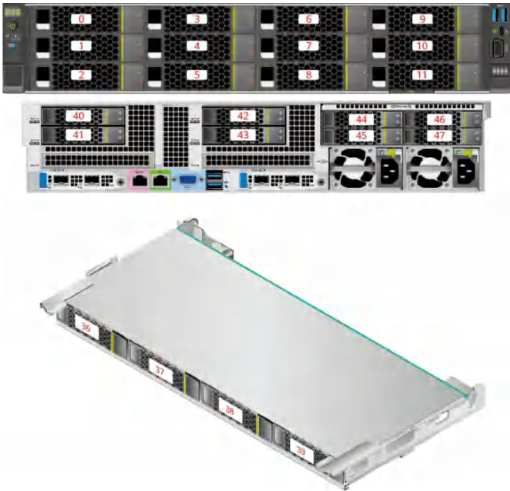
图2-47 硬盘编号（IO 模组 1 和 IO 模组 2 配置2.5 英寸硬盘）
