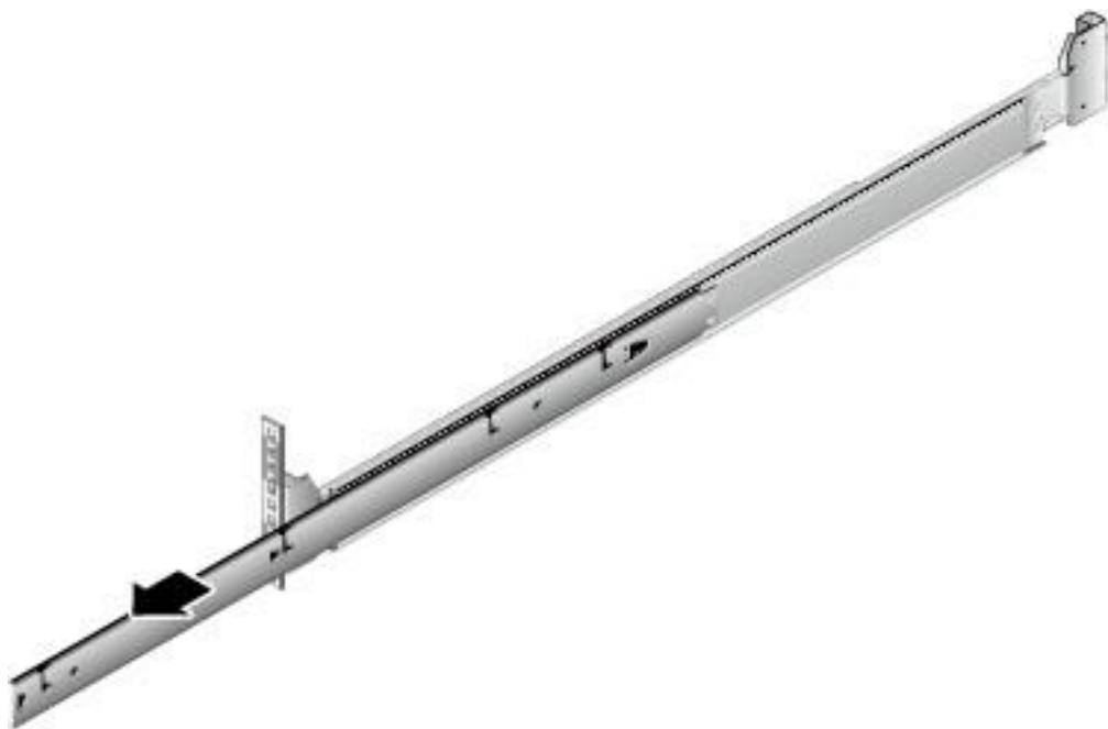
2. 至少两人从服务器两侧水平抬起，将服务器上的固定钉对准内轨的固定孔位，沿箭头方向推动，直到听见“咔”的一声，确保卡扣弹起完全挡住挂钉，使服务器固定到内轨上，如图7-10中①和②所示。
