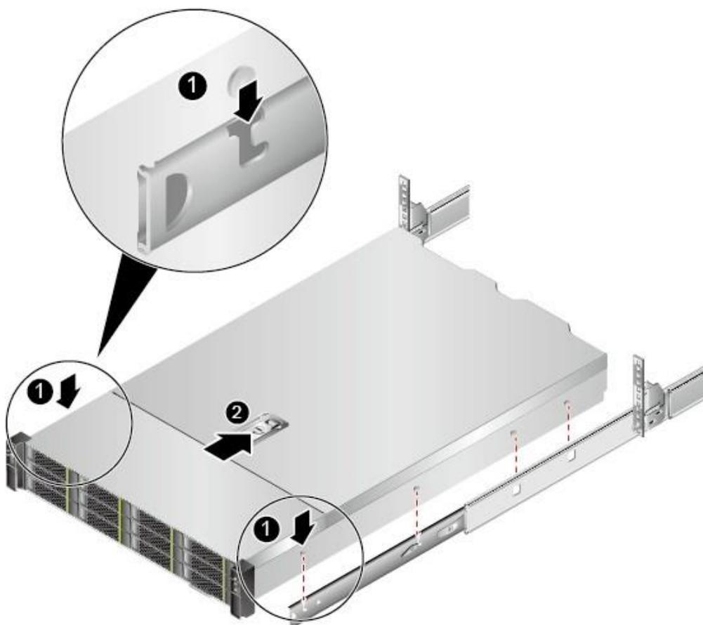
3. 按住服务器两侧的解锁按钮，将服务器推入轨道，如图7-11中①和②所示。
