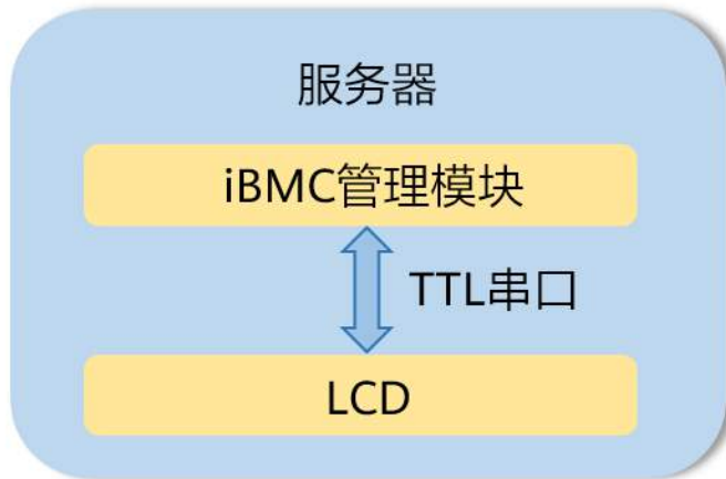
图2-91 LCD 子系统工作原理
